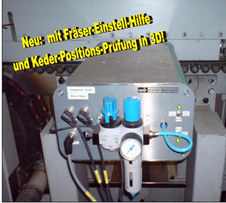
GROOVE checker 3D, tek ya da iki kafalı-3D kontrol sistemi
